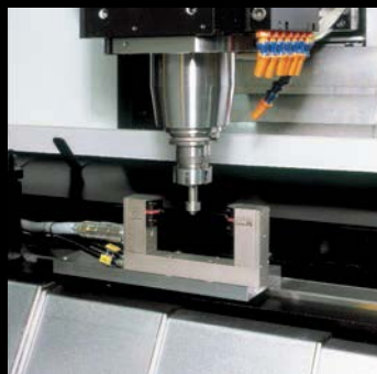
TARATURA UTENSILI LASER LASER TOOLS SETTING DEVICE
