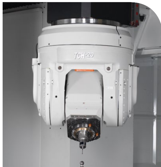
Esempio di testa con doppia flangia Example of head with double flange
