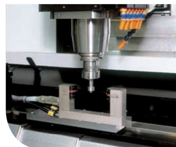
Taratura utensili laser Laser tools setting device
