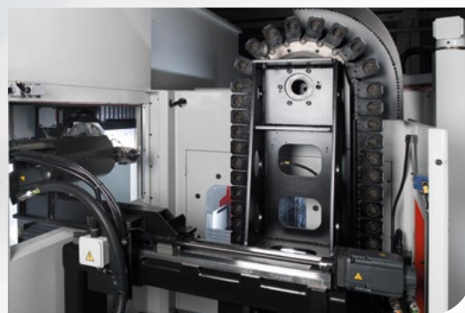
Magazzino a catena con braccio di scambio Chain magazine with exchanging arm
